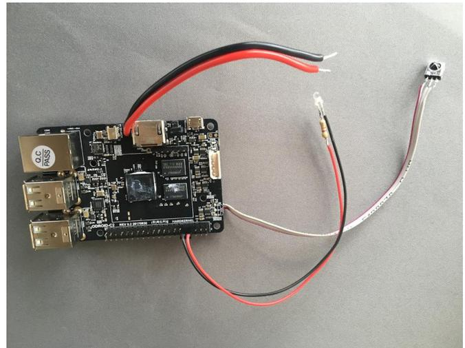
Figure 4 - ODROID-C2 Wiring
