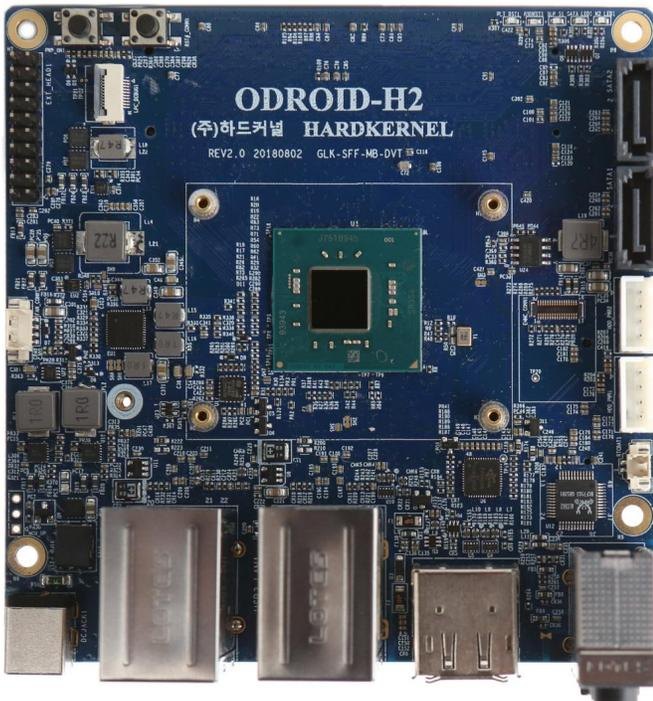
Figure 3 - Closeup of ODROID-H2 PCB
