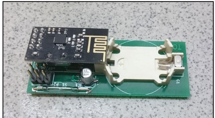
Figure 2 Nrf24 Window Sensor
