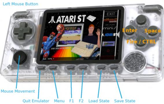
**Figure 10 - Atari ST Button Mapping**
